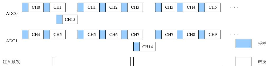
如果在一个注入转换期间，另一个注入触发出现，那么后面的这个触发将会被忽略，如 [图 11-21. 在注入转换过程中触发出现](#) 所示。
