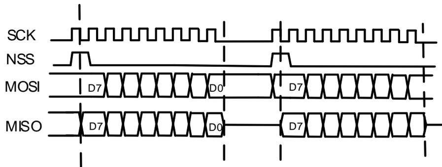
图 18-8. 主机 TI 模式在连续发送时的时序图
