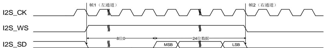
**图 18-29. LSB 对齐标准时序图 (DTLEN=01, CHLEN=1, CKPL=1)**
