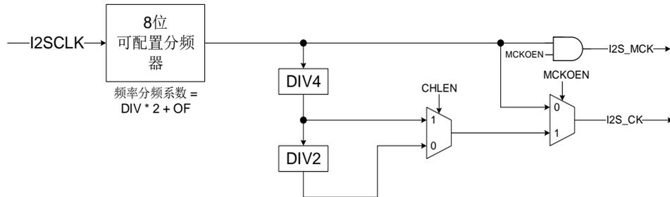
I2S 时钟生成器框图如 [图 18-48. I2S 时钟生成结构框图](#) 所示。I2S 接口时钟是通过 SPI\_I2SPSC 寄存器的 DIV 位, OF 位和 MCKOEN 位以及 SPI\_I2SCTL 寄存器的 CHLEN 位来配置的。时钟源是系统时钟 (CK\_SYS)。I2S 比特率可以通过 [表 18-4. I2S 比特率计算公式](#) 所示的公式计算。
