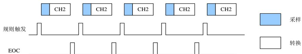
规则通道单次转换结束后，转换数据将被存放于 ADC\_RDATA 寄存器中，EOC 将会置 1。如果 EOCIE 位被置 1，将产生一个中断。
