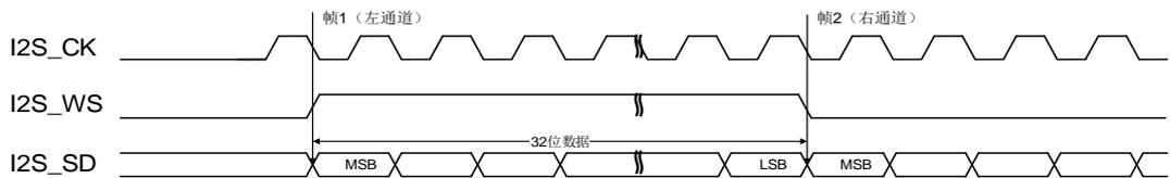
**图 18-23. MSB 对齐标准时序图 (DTLEN=10, CHLEN=1, CKPL=1)**
