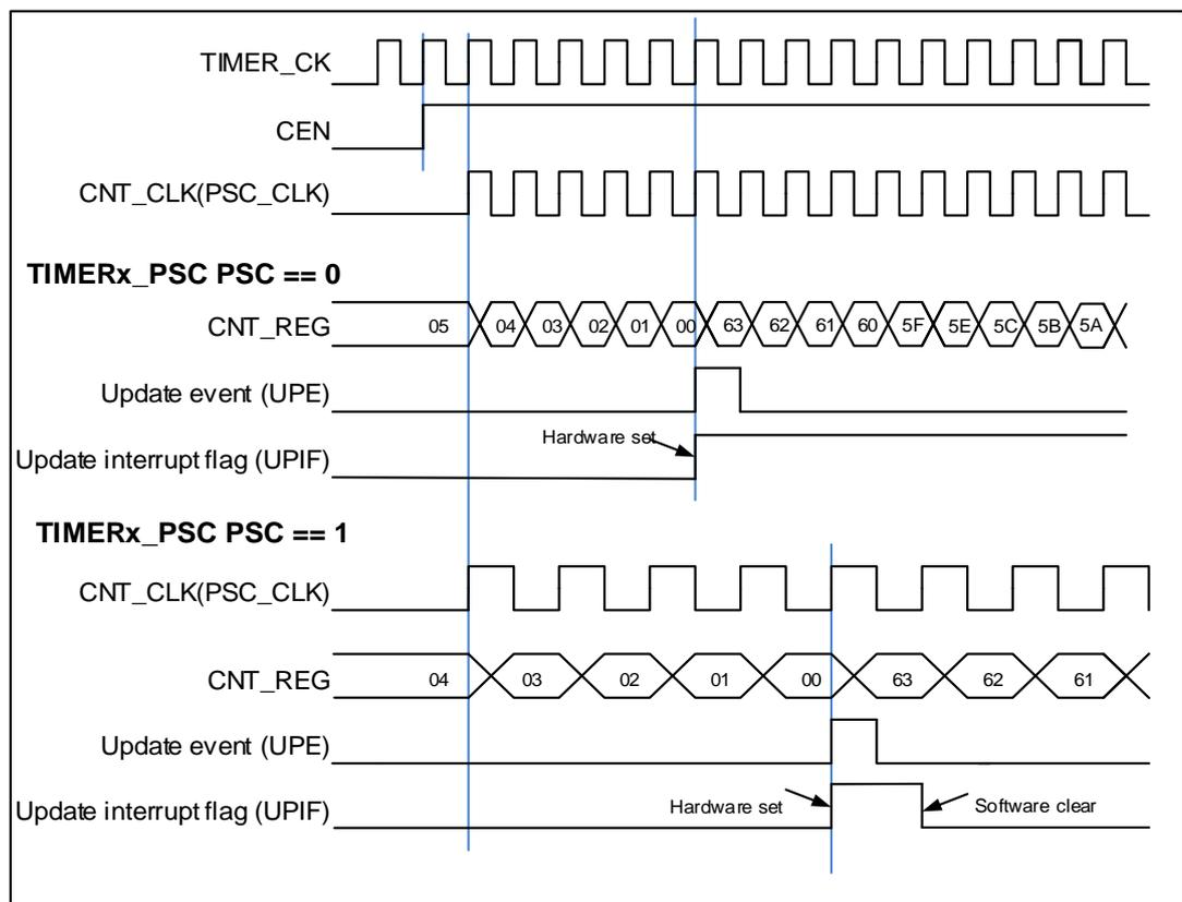
图 15-7. 向下计数时序图，在运行时改变 TIMERx\_CAR 寄存器值
