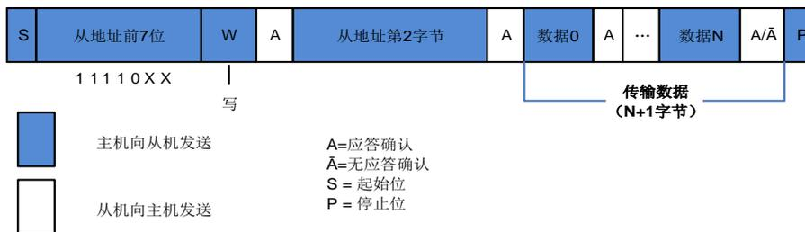
图 17-8. 10 位地址的 I2C 通讯流程（主机接收）
