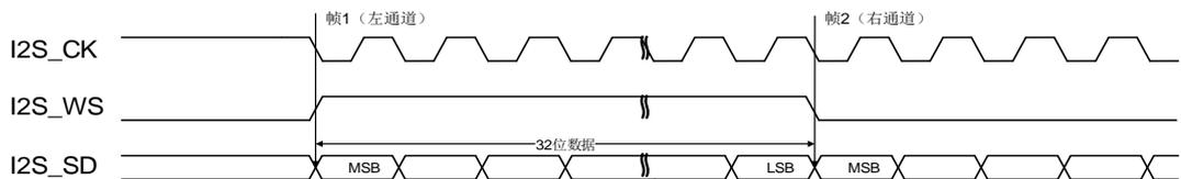
**图 18-24. MSB 对齐标准时序图 (DTLEN=01, CHLEN=1, CKPL=0)**
