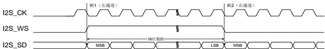
**图 18-21. MSB 对齐标准时序图 (DTLEN=00, CHLEN=0, CKPL=1)**
