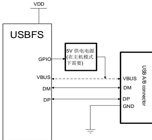
当 USBFS 工作在主机模式下时（FHM 控制位置位、PDM 控制位置清除），VBUS 为 USB 协议所定义的 5V 电源检测引脚。内部 PHY 不能提供 5V VBUS 电源，仅在 VBUS 信号线上具有电压比较器和充电放电电路。所以，如果应用需要提供 VBUS 电源，那么则需要一个外部的供电电源 IC。在主机模式下，USBFS 和 USB 接头之间的 VBUS 连接可以被忽略，这是由于 USBFS 并不检测 VBUS 引脚的电平状态，并假定 5V 供电电源一直存在。
