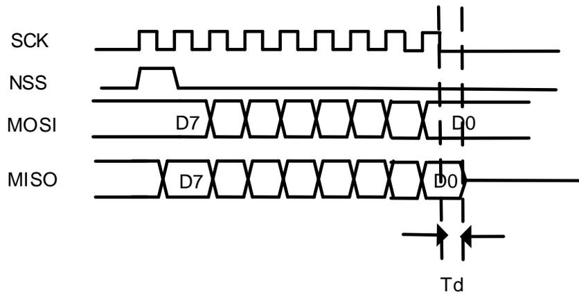
在从机TI模式中，在SCK信号的最后一个上升沿，从机开始发送最后一个字节的LSB位，在半位的时间之后，主机开始采集数据。为了确保主机采集到正确的数据，在释放该引脚之前，从机需要在SCK信号的下降沿之后继续驱动该位一段时间，这段时间称为 $T_d$ ， $T_d$ 通过SPI\_CTL0寄存器中的PSC[2:0]位来设置。
