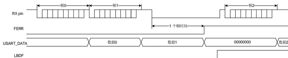
如 [图 16-10. 数据传输过程中检测断开帧](#) 所示，如果断开帧发生在数据传输过程中，当前传输帧发生错误，FERR 置位。
