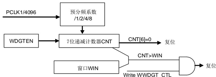
上电复位之后看门狗定时器总是关闭的。软件可以向 WWDGT\_CTL 的 WDG TEN 写 1 开启看门狗定时器。窗口看门狗定时器打开后，计数器始终递减计数，计数器配置的值应该大于 0x3F，也就是说 CNT[6]位应该被置 1。CNT[5:0]决定了两次重载之间的最大间隔时间。计数器的递减速度取决于 APB1 时钟和预分频器(WWDGT\_CFG 寄存器的 PSC[1:0]位)。
