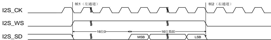
**图 18-31. LSB 对齐标准时序图 (DTLEN=00, CHLEN=1, CKPL=1)**
