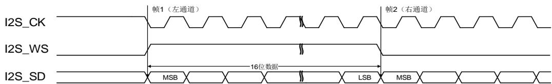
**图 18-22. MSB 对齐标准时序图 (DTLEN=10, CHLEN=1, CKPL=0)**
