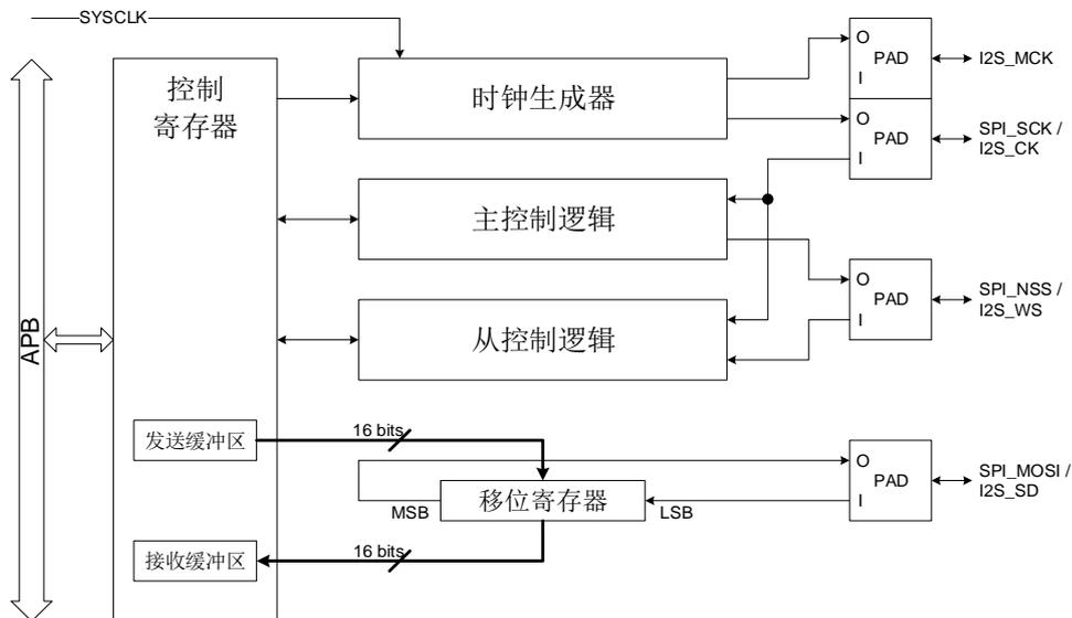
I2S功能有5个子模块，分别是控制寄存器、时钟生成器、主机控制逻辑、从机控制逻辑和移位寄存器。所有的用户可配置寄存器都在控制寄存器模块实现，其中包括发送缓冲区和接收缓冲区。时钟生成器用来在主机模式下生成I2S通信时钟。主机控制逻辑用来在主机模式下生成I2S\_WS信号并控制通信。从机控制逻辑根据接收到的I2S\_CK和I2S\_WS信号来控制从机模式的通信。移位寄存器控制I2S\_SD上的串行数据发送和接收。
