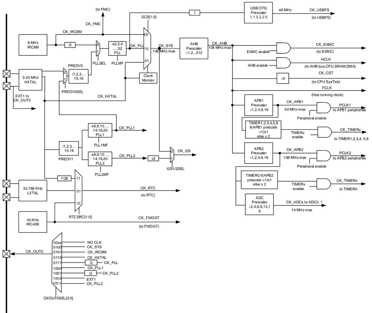
预分频器可以配置AHB、APB2和APB1域的时钟频率。AHB、APB2、APB1域的最高时钟频率分别为108MHz、108MHz、54MHz。RCU通过AHB时钟(HCLK)8分频后作为RISC-V系统定时器(SysTick)的外部时钟。通过对SysTick控制和状态寄存器的设置，可选择上述时钟或AHB(HCLK)时钟作为SysTick时钟。
