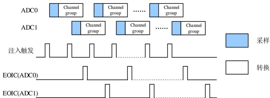
如果使能 ADC0 和 ADC1 中断模式，当第一次触发发生，ADC0 转换第一组注入通道。当第二次触发发生，ADC1 转换第一组注入通道。然后，ADC0 转换第二组注入通道，ADC1 转换第二组通道，以此类推。
