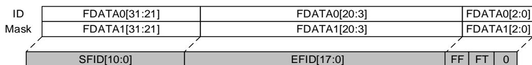
图 20-8. 16-bit 位宽掩码模式过滤器
