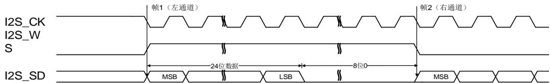
**图 18-26. MSB 对齐标准时序图 (DTLEN=00, CHLEN=1, CKPL=0)**
