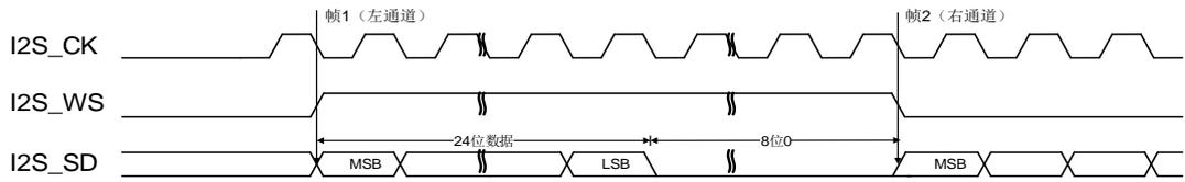
**图 18-25. MSB 对齐标准时序图 (DTLEN=01, CHLEN=1, CKPL=1)**
