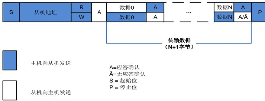
图 17-7. 10 位地址的 I2C 通讯流程（主机发送）
