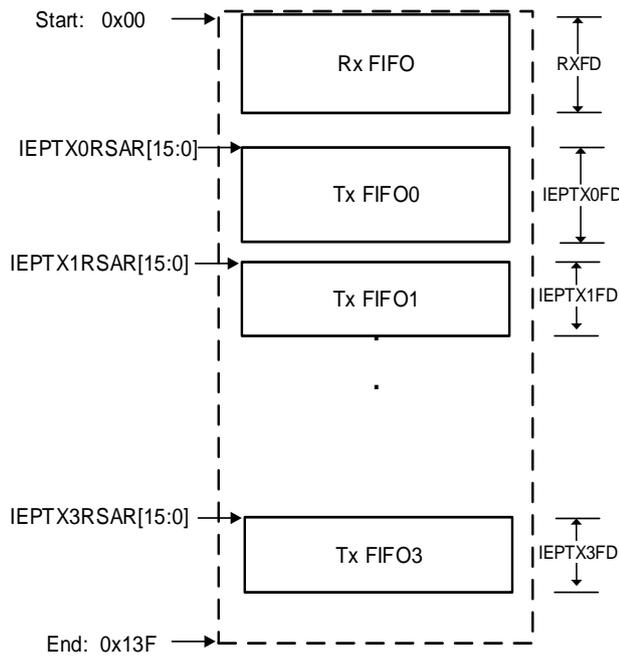
USBFS 为程序提供了专有寄存器空间来读写数据 FIFO。[图 21-8. 设备模式 FIFO 访问寄存器映射表](#)所描述的是数据 FIFO 所访问的寄存器存储空间，图中的数值是以字节为单位寻址。每个端点都拥有它们的 FIFO 访问寄存器空间。通过寄存器 USBFS\_GRXTATR/USBFS\_GRSTATP 来访问 Rx FIFO。
