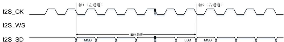
图 18-13. I2S 飞利浦标准时序图 (DTLEN=00, CHLEN=0, CKPL=1)
