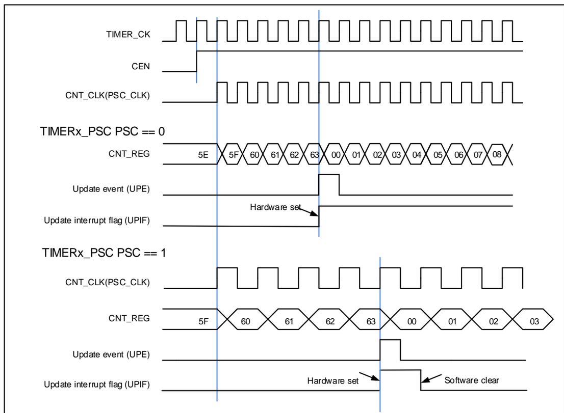
图 15-56. 向上计数时序图，在运行时改变 **TIMERx\_CAR** 寄存器的值
