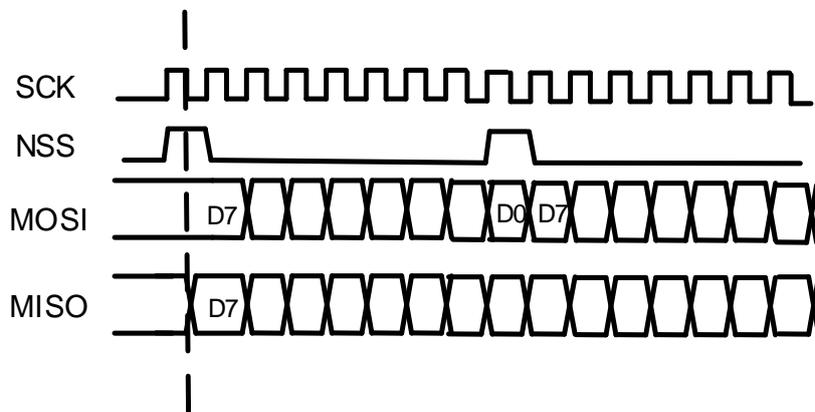
在主机TI模式下，SPI模块可实现连续传输或者不连续传输。如果主机写SPI\_DATA的速度很快，那么就是连续传输，否则，为不连续传输。在不连续传输中，在每个字节传输前需要一个额外的时钟周期。在连续传输中，额外的时钟周期只存在于第一个字节之前，随后字节的起始时钟周期被前一个字节的最后一位的时钟周期覆盖。
