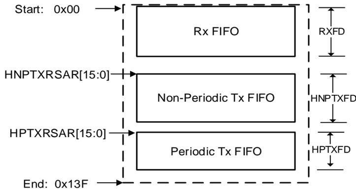
USBFS 为程序提供了专有寄存器空间来读写数据 FIFO。[图 21-6. 主机模式 FIFO 访问寄存器映射表](#)所描述的是数据 FIFO 所访问的寄存器存储空间，图中的数值是以字节为单位寻址。尽管所有的非周期通道共享相同的 FIFO 以及所有的周期通道共享相同的 FIFO，每个通道都拥有它们的 FIFO 访问寄存器空间。对 USBFS 而言，获知当前压入数据包的通道号是非常重要的，通过寄存器 USBFS\_GRXTATR/USBFS\_GRSTATP 来访问数据包所从属的 Rx FIFO。
