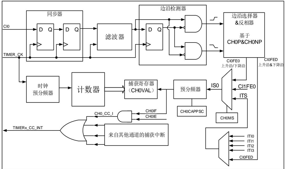
通道输入信号  $Ci_x$  有两种选择，一种是  $TIMERx\_CHx$  信号，另一种是  $TIMERx\_CH0$ ， $TIMERx\_CH1$  和  $TIMERx\_CH2$  异或之后的信号。通道输入信号  $Ci_x$  先被  $TIMER\_CK$  信号同步，然后经过数字滤波器采样，产生一个被滤波后的信号。通过边沿检测器，可以选择检测上升沿或者下降沿。通过配置  $CHxP$  选择使用上升沿或者下降沿。通过配置  $CHxMS$ ，还可以选择其他通道的输入信号或内部触发信号作为捕获信号。配置  $IC$  预分频器，使得若干个输入事件后才产生一个有效的捕获事件。捕获事件发生， $TIMERx\_CHxCV$  存储计数器的值。
