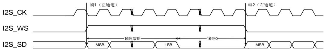
**图 18-27. MSB 对齐标准时序图 (DTLEN=00, CHLEN=1, CKPL=1)**
