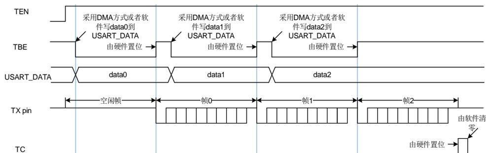
在禁用 USART 或进入低功耗状态之前, 必须等待 TC 置位。先读 USART\_STAT 然后再写 USART\_DATA 可将 TC 位清 0。在多级缓存通信方式(DENT=1)下, 直接向 TC 写 0, 也能清
