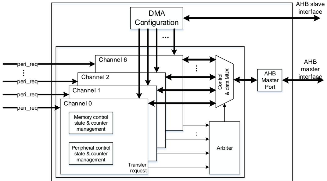
由图 9-1. DMA 结构框图所示，DMA 控制器由 4 部分组成：
