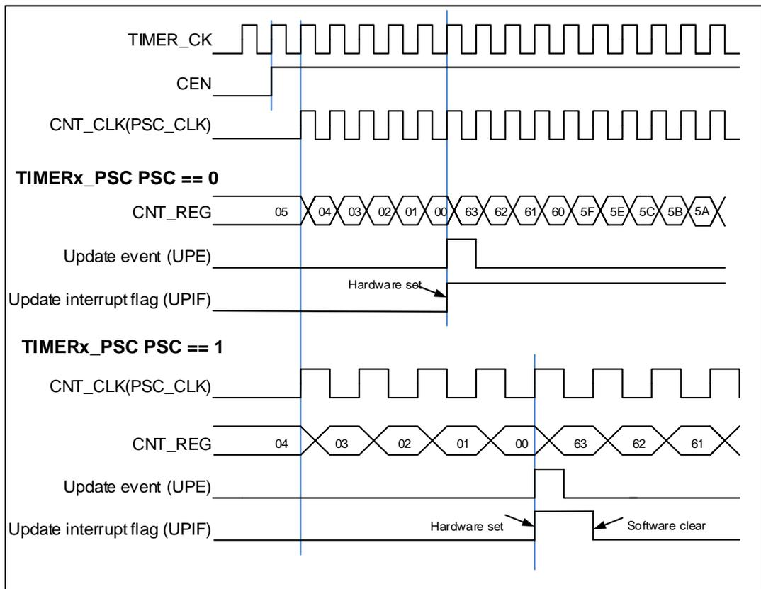
图 15-40. 向下计数时序图，在运行时改变 **TIMERx\_CAR** 寄存器值
