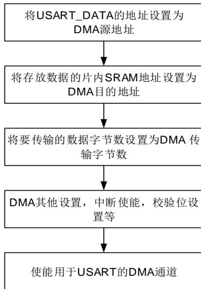
当 USART 接收到的数据数量达到了 DMA 传输数据数量，DMA 模块将产生传输完成中断。
