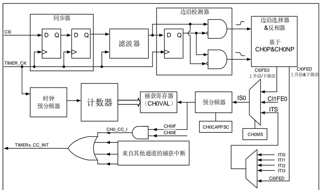
通道输入信号  $Clx$  有两种选择，一种是  $TIMERx\_CHx$  信号，另一种是  $TIMERx\_CH0$ ， $TIMERx\_CH1$  和  $TIMERx\_CH2$  异或之后的信号。通道输入信号  $Clx$  先被  $TIMER\_CK$  信号同步，然后经过数字滤波器采样，产生一个被滤波后的信号。通过边沿检测器，可以选择检测上升沿或者下降沿。通过配置  $CHxP$  选择使用上升沿或者下降沿。通过配置  $CHxMS$ ，还可以选择其他通道的输入信号或内部触发信号作为捕获信号。配置  $IC$  预分频器，使得若干个输入事件后才产生一个有效的捕获事件。捕获事件发生， $TIMERx\_CHxCV$  存储计数器的值。
