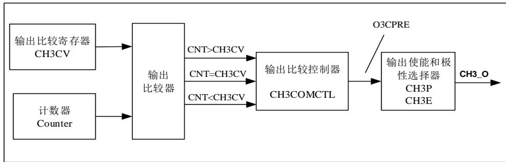
图 15-13. 输出比较逻辑（带有互补输出的通道， $x=0,1,2$ ）和图 15-14. 输出比较逻辑分别给出了输出比较的逻辑电路。通道输出信号  $CHx\_O/CHx\_ON$  与  $OxCPRE$  信号（详情请见通道输出准备信号）的关系描述如下： $OxCPRE$  信号高电平有效， $CHx\_O/CHx\_ON$  的输出情况与  $OxCPRE$  信号， $CHxP/CHxNP$  位和  $CHxE/CHxNE$  位有关（具体情况请见  $TIMERx\_CHCTL2$  寄存器中的描述）。例如：
